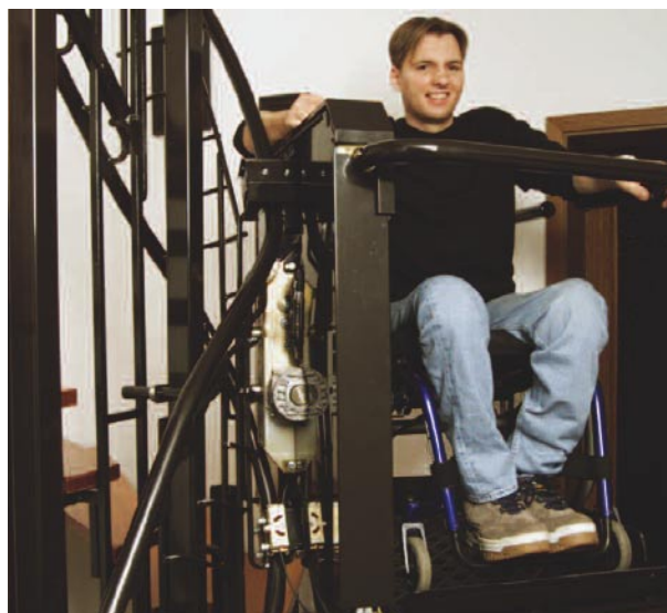
Treppensteiger – anwendbar für enge oder Wendeltreppen, nur mit Hilfsperson brauchbar Treppenlifter
